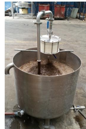
Si se elige la opción de salida , el fango sale con 40% de humedad, si se opta por la opción con secador , este sale con humedad de 12%, para el secador se canaliza el aire de combustión de las calderas de combustión.
